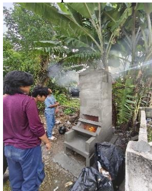
Gambar 6. Uji coba pembakaran sampah dengan rocket stove
